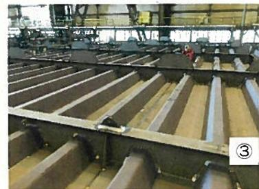
**④創意工夫 - 25m パネルでの補剛桁ブロック製作**
