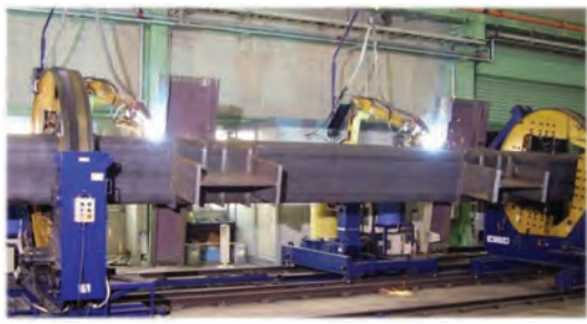
多関節型ロボットを用いた自動溶接システム
